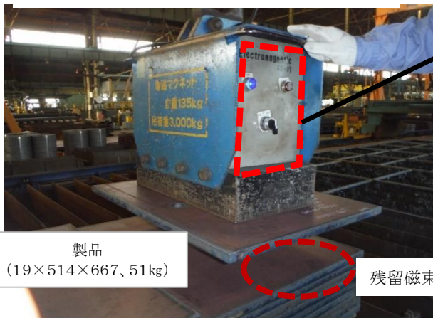
励磁SWオフ後、約5秒間、吊り状態保持(残留磁束残存)後、落下
